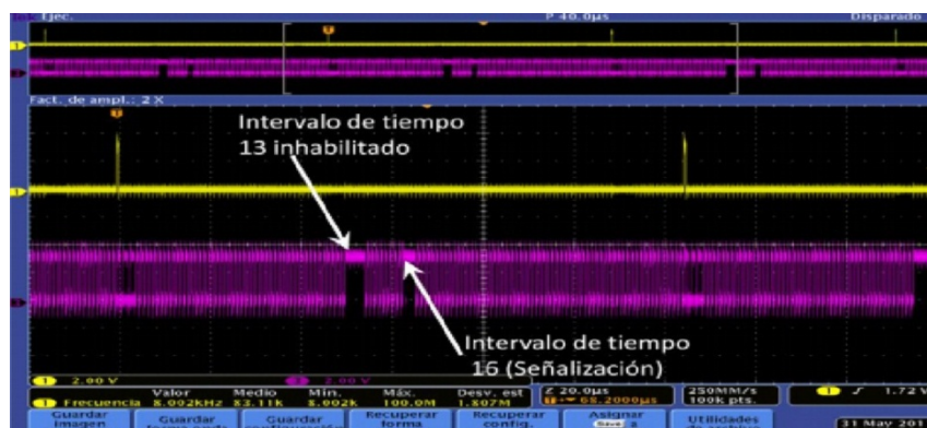
Fig. 11. Implementación de la interfaz con el microprocesador MEMORM2.
